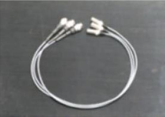
11. Tres adaptadores para la conexión de los transductores analógicos. Longitud 1 m; terminado con un conector de 3 pines en un lado, y con 4 bananas en el otro.
