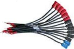
8. Ocho cables cortos, para poner en común la alimentación de las bobinas.
