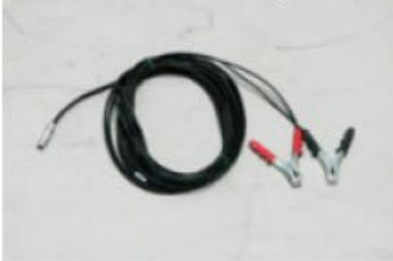
5. Un conjunto de pinzas cocodrilos, 16 en total, con diferentes colores, para la conexión de los contactos auxiliares y para la conexión de las entradas de medición de 500 V.
