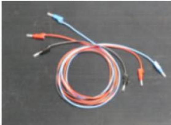
7. Un conjunto de adaptadores de los enchufes bananas a terminaciones en punta, 20 en total, de diferentes colores, para los contactos auxiliares y para las entradas de bobina.
