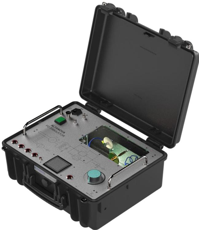
Le simulateur de DP de TECHIMP est un appareil portable conçu pour démontrer les phénomènes typiques de décharge partielle (corona, superficielle, interne) présents dans tous les actifs électriques HTA et HTB.
